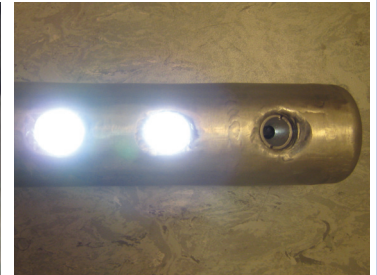
Zwei kräftige LED's sind in der wassergekühlten Kamera untergebracht.
