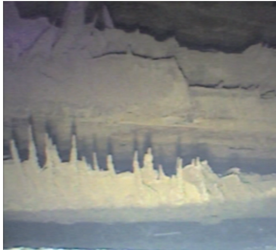
Ascheanbackungen im Eco einer Müllverbrennungsanlage
