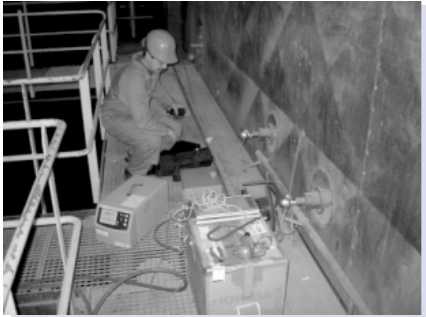
Kostas Mavroudis i full färd med sugpyrometern och gasanalyssystemet
