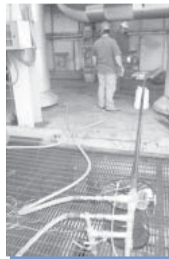
Med hjälp av en sk sugpyrometer är vi redo att börja kartlägga förhållandena i eldstaden
